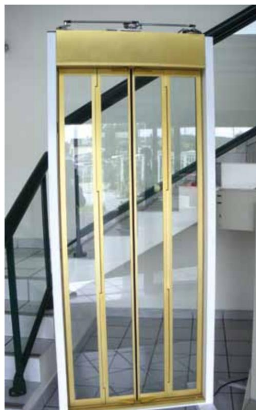
Le porte a battente di piano possono essere fornite da luce 500 mm fino a grandi dimensioni per montacarichi o montauto, in esecuzione standard, rinforzata e con certificazione tagliafuoco fino ad EI 120. Sono normalmente ad apertura manuale e dotate di serratura di sicurezza sbloccata direttamente dalla presenza della cabina al piano.
